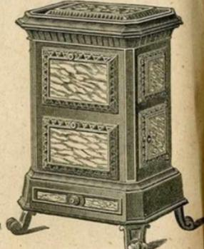
Cheminées avec foyer pour brûler la houille et le bois. Elles sont toujours livrées avec les deux grilles : à houille et à bois. Le foyer est garni de briques réfractaires. La flamme circule autour du four. Le couvercle est à charnières : il couvre un dessus avec deux trous et tampons.
