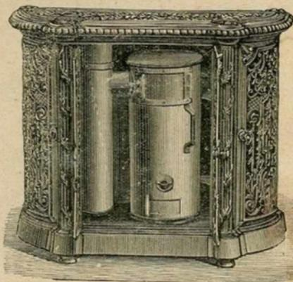
Ce foyer est formé d'un cylindre en tôle avec grille et cendrier mobile. Il tourne sur un axe qui sert en même temps de tuyau de fumée. Ce système permet de faire sortir le foyer du meuble pour que la chaleur se répande plus vite dans l'appartement. Sur demande, les N<sup>os</sup> 34 à 36 sont livrés avec foyer fonte.
