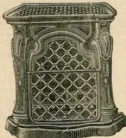
La cheminée N<sup>o</sup> 34 se fait indifféremment pour l'usage du bois et de la houille; sauf avis contraire, elle est livrée au bois. Le foyer est composé de pièces en fonte. Le souffleur est à crémaillères; il peut être remplacé, sur demande, par un souffleur portatif en tôle métallique. **Sauf avis contraire, elle est expédiée à buse derrière et, sur demande, à buse dessus.**
